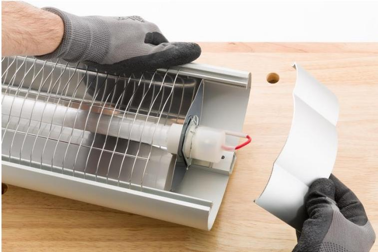
**Schritt 4:** Entfernen Sie das silberne Auflageblech. Dieses kann einfach seitlich herausgeschoben werden.
