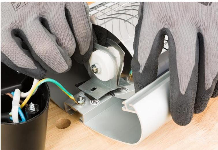
**Schritt 8:** Ziehen Sie alle gelösten Bauteile ab, der Zugang zum Leuchtmittel liegt nun frei.
