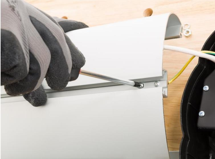
**Schritt 7:** Drehen Sie den Infrarotheizstrahler auf den Kopf und lösen Sie die innere Schraube an der Rückseite, um die Halterung der Röhre zu lockern. Vergessen Sie nicht, die Schraube auf der Gegenseite zu kontern.
