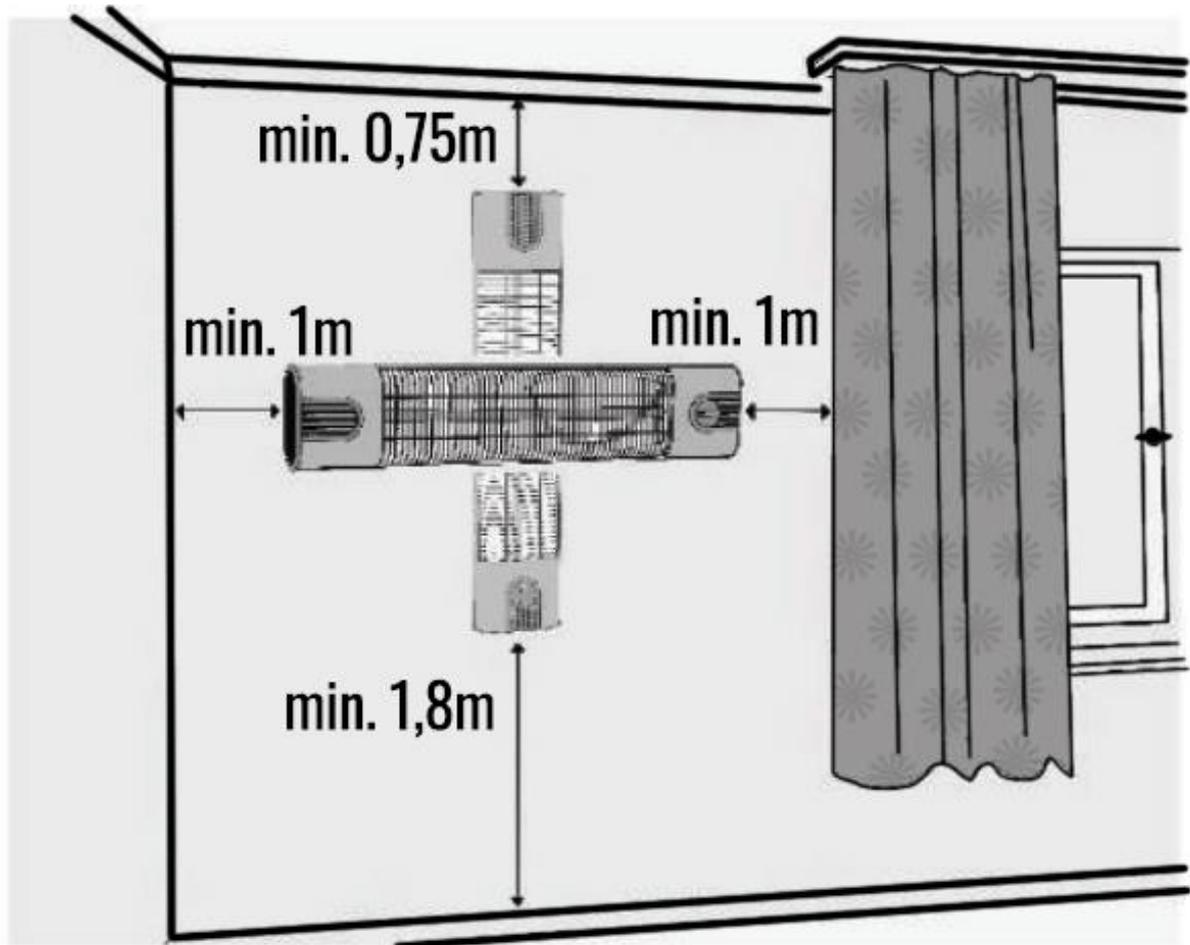
**Beachte: Keine vertikale Montage möglich, Bild dient nur zur Abstandsverdeutlichung!**
