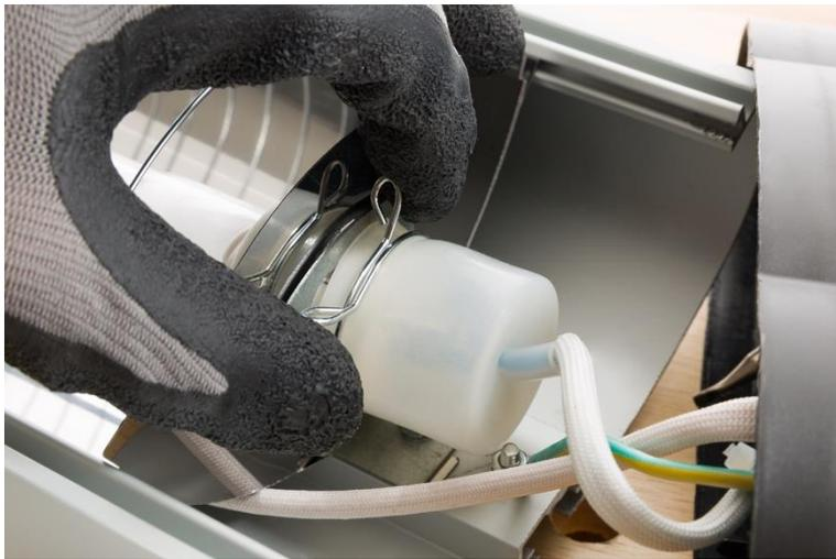
**Schritt 5:** Die Verteilerdose wird sichtbar. Um den Zugang zu den weiteren Bauteilen freizulegen, ziehen Sie die Kappe ein Stück zur Seite.
