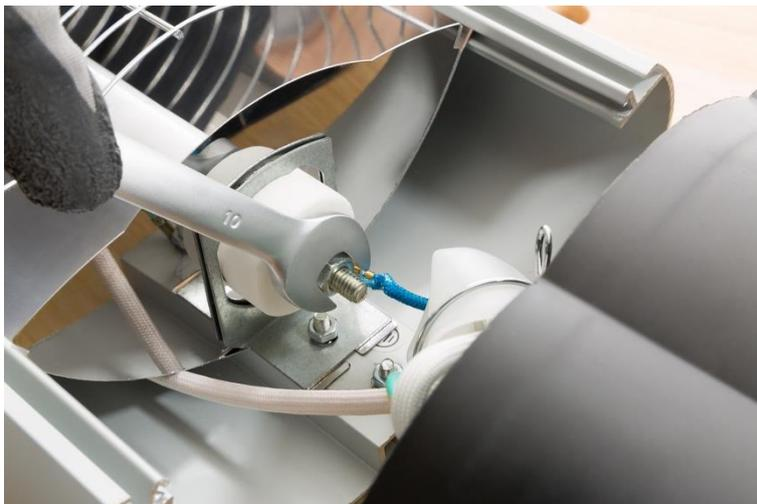
**Schritt 6:** Lösen Sie mit einem Schraubenschlüssel oder einer Zange die Mutter (und den nachgesteckten Ring), welche die Kabelzufuhr sichert.
