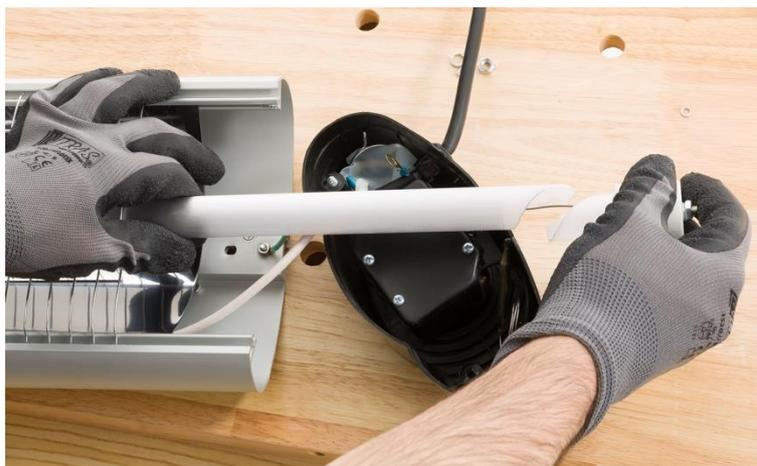
**Schritt 9:** Die defekte Röhre kann problemlos herausgezogen und ausgetauscht werden. Für die Installation der neuen Heizröhre gehen Sie bitte in umgekehrter Reihenfolge vor.
