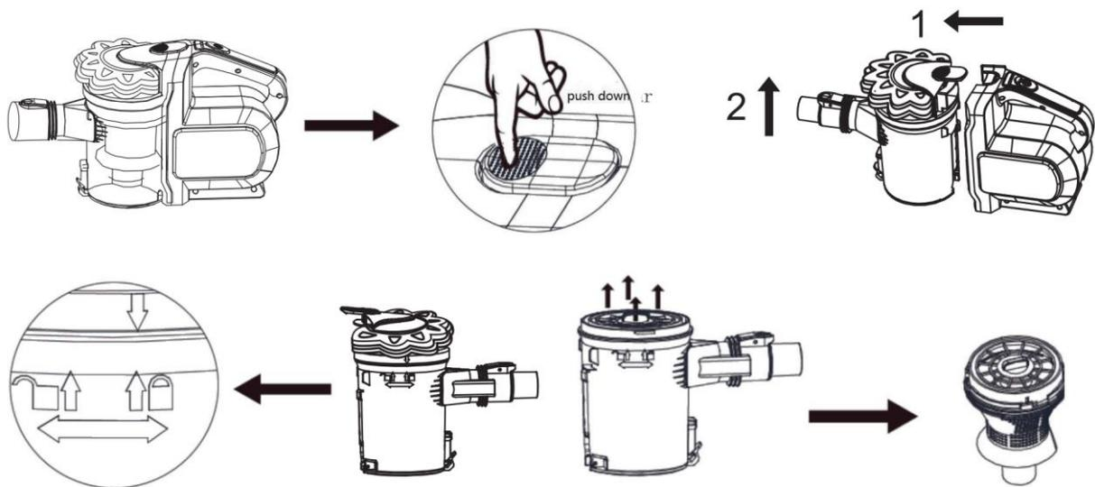
2.1. Drücken Sie auf die punktierte Fläche der Taste (1), um den Staubbehälter vom Motorgehäuse zu trennen.
