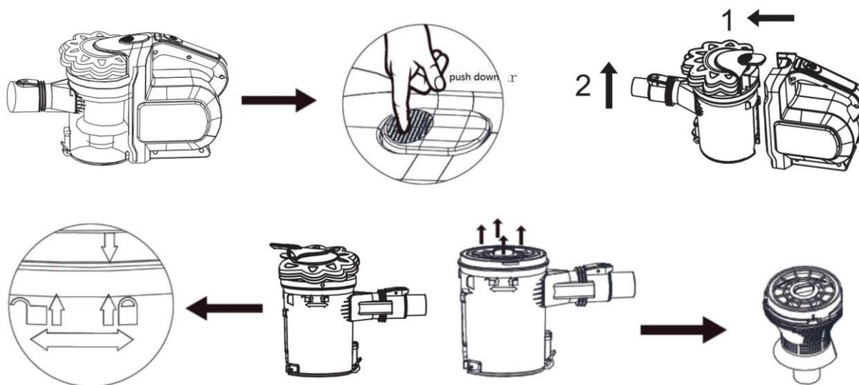
2.1. Premere la superficie tratteggiata del pulsante (1) per scollegare il contenitore della polvere dall'alloggiamento del motore.
