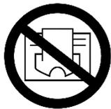
**⚠ ¡ADVERTENCIA!** ¡El calentador no debe estar cubierto para evitar el sobrecalentamiento y el riesgo de incendio!
