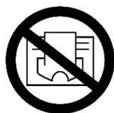
**⚠ AVERTISSEMENT!** L'appareil de chauffage ne doit pas être couvert pour éviter la surchauffe et les risques d'incendie!
