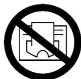
**⚠ AVERTISSEMENT!** L'appareil de chauffage ne doit pas être couvert pour éviter la surchauffe et les risques d'incendie!
