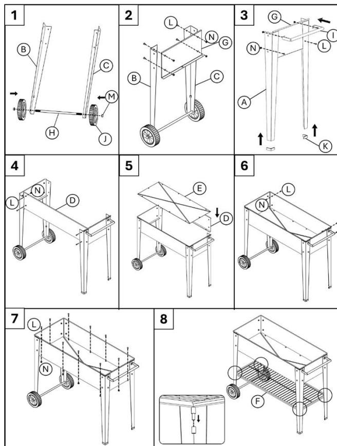
Richten Sie die Löcher in der Bodenplatte (E) an denen in den Leisten aus. Setzen Sie Schrauben in jeden Lochsatz ein, beginnend mit der unteren Abdeckung. Befestigen Sie jede Schraube locker mit einer Mutter.
