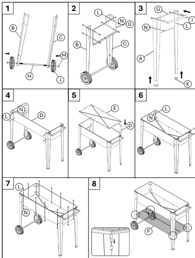
Alignez les trous de la plaque de base (E) avec ceux des plinthes. Insérez des vis dans chaque ensemble de trous, en commençant par le couvercle inférieur. Fixez chaque vis sans serrer avec un écrou.
