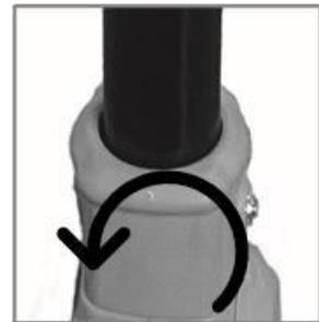
NOTA: Asegúrese de que el bloqueo a presión permanezca en su lugar hasta que la columna de dirección esté completamente extendida y firmemente asentada. Antes de usar, verifique que todas las piezas sean estables y seguras.
