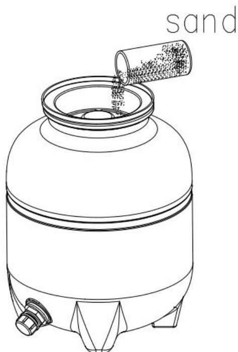
**Attenzione:** Evitare di inalare la polvere. Quando si riempie il serbatoio, utilizzare una maschera respiratoria approvata per la protezione di polvere, sabbia e occhi.
